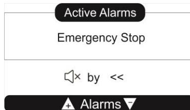
خطای رخ داده قرار نخواهد گرفت. اگر خطا از نوع Warning انتخاب شده باشد، با وقوع خط سیستم متوقف نشده و فقط یک پیغام هشدار مبنی رخ دادن خطا اعلام می‌کند و همزمان چراغ قرمز رنگ نمایشگر خطا شروع به چشمک زدن کرده و بازرنیز فعال می‌گردد. در حالت Immediate Stop، با رخ دادن خطا کمپرسور بصورت آنی متوقف شده و پیغام خطا که نشان‌دهنده علت بوجود آمدن شرایط خطا در سیستم است نمایش داده می‌شود.
